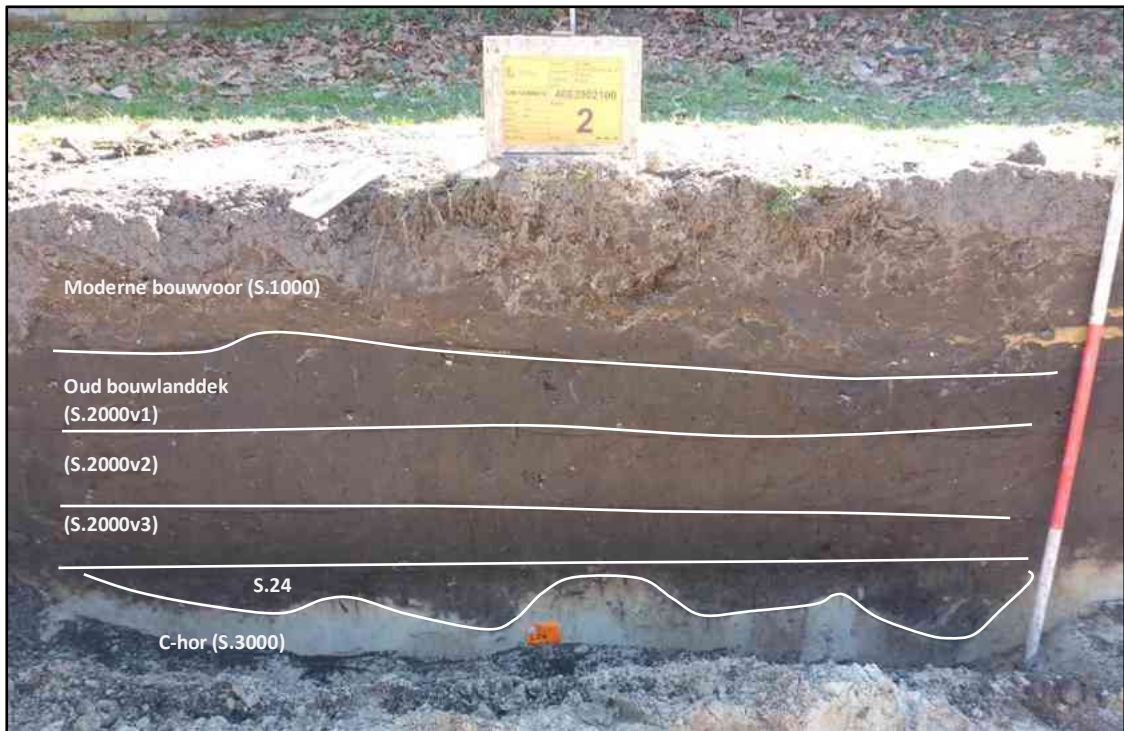
Figuur 8. Profielkolom 11, representatief voor de bodemopbouw aan de zuidwestzijde van het plangebied.
